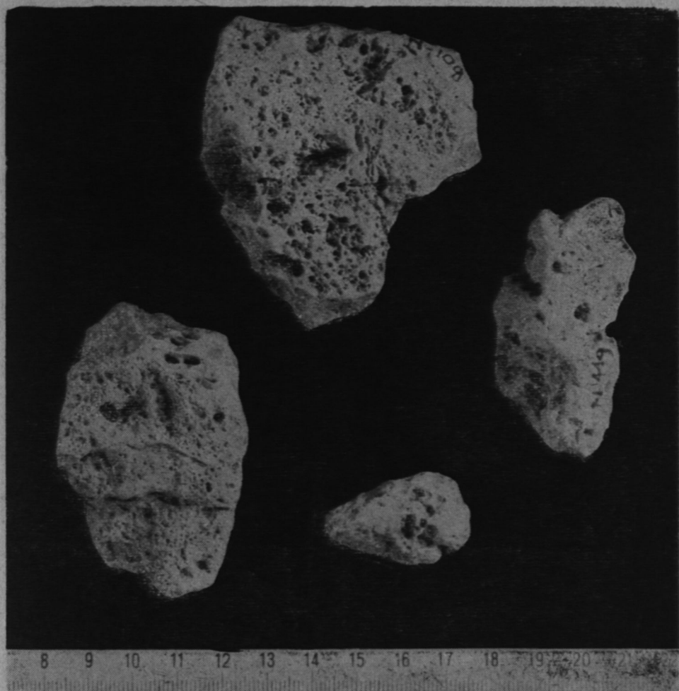
Ryc. 6. Gruz wapienny o ogładzonych krawędziach, czyli słaboogładzony z jamkowatym zagłębieniami korozyjnymi na powierzchniach — grupa morfologiczna IIB (fot. E. Buczek)
