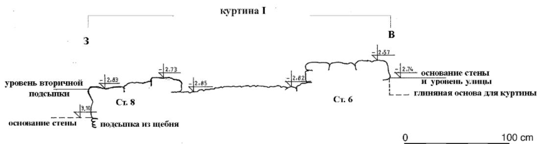
Fig. 62. Разрез по линии 3-В через куртину I
